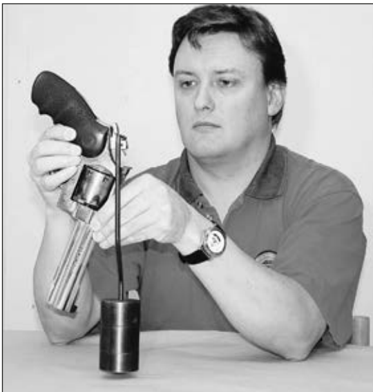
Bild 2: Kontroll av upphakningsmotstånd.
